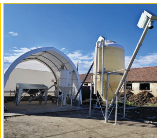
Фуражна кухня в дъговидно хале; полиестерен външен силоз, гр. Левски
