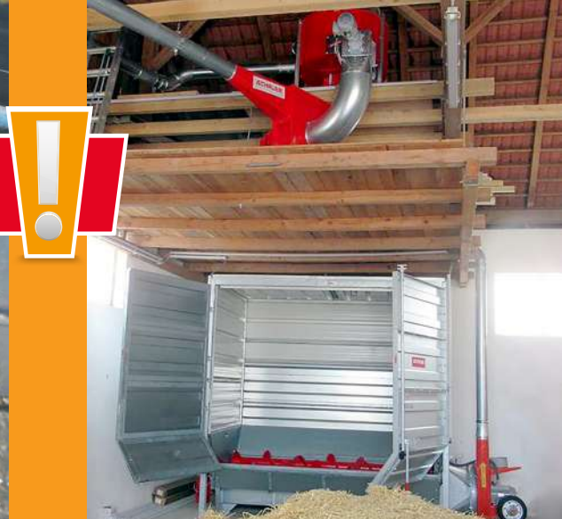
Бункер за бали и трансферен модул със смукателна тръба
